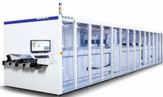
RENA BatchTex N400: Anlage für die alkalische Texturierung von monokristallinem Silizium
