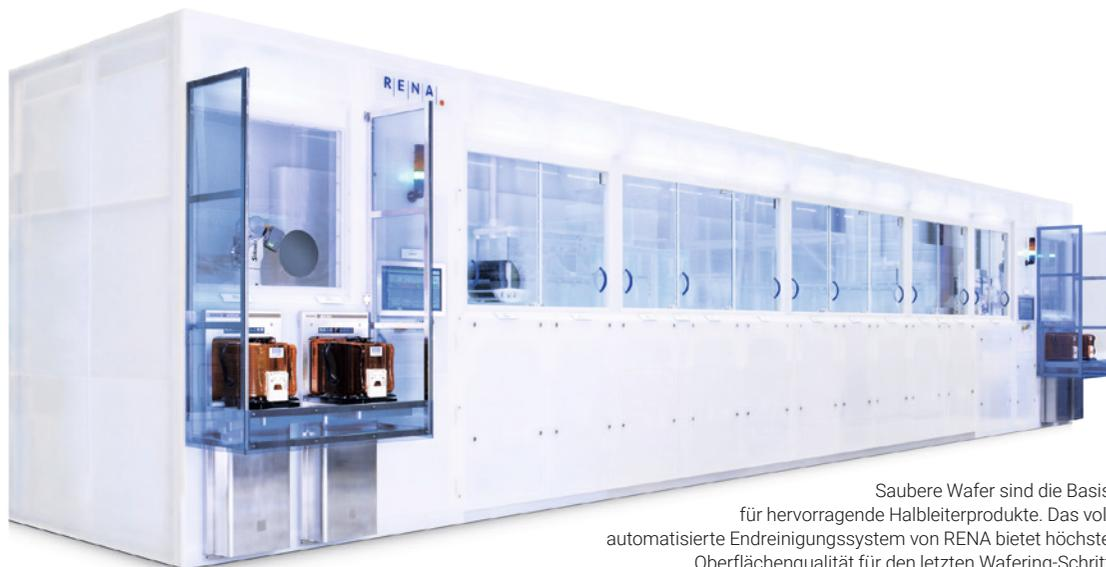
Saubere Wafer sind die Basis für hervorragende Halbleiterprodukte. Das voll automatisierte Endreinigungssystem von RENA bietet höchste Oberflächenqualität für den letzten Wafering-Schritt
